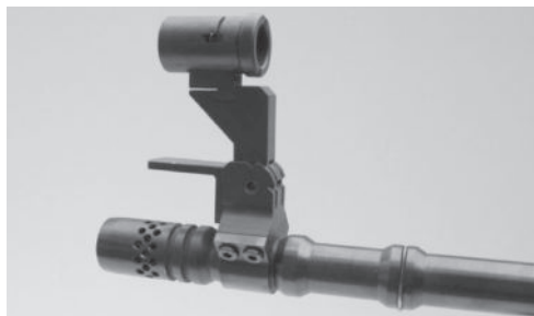
Figura 25: portamirino come prolungamento della linea di mira (montaggio sulla canna), diversi modelli
